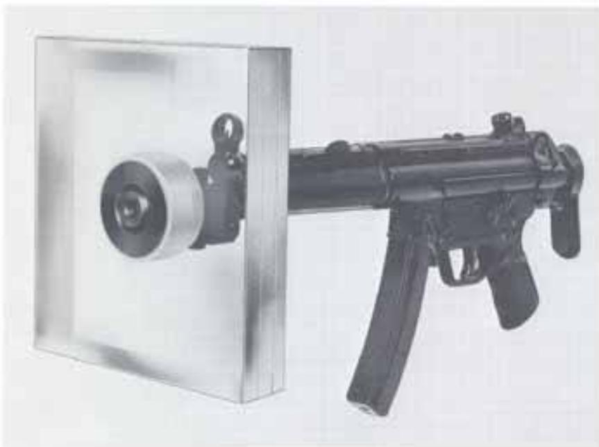
Die Lagerung der Kugellafette ist innerhalb einer Panzerglasscheibe.
