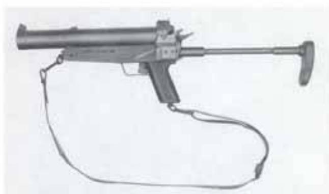
Vor dem Hahn liegt der Schließhebel zur Verriegelung des Kippllaufes.
