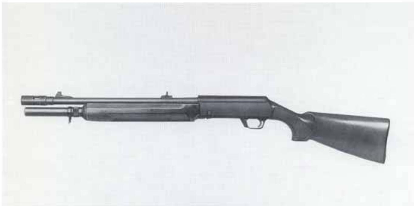
Die Selbstlade-Schrotflinte HK 512 ist eine halbautomatische Waffe im Kaliber 12/70. Sie ist ein Gasdrucklader mit Stützklappenverschluss und einer Magazinkapazität von 7 Patronen. An der Mündung ist ein Schrotverteiler angebracht, der die Schrotgarbe auf einen Rechteckquerschnitt verteilt.
