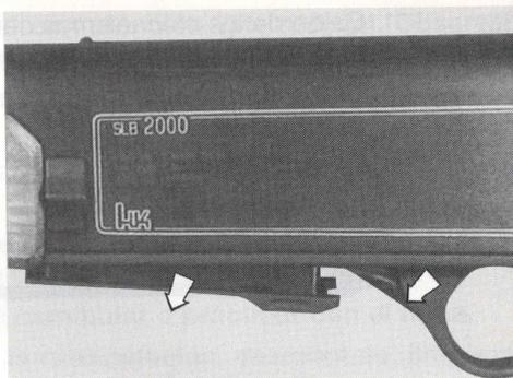
Introducir el cargador lleno horizontalmente en el pozo del cargador. Primero empujar parte delantera del cargador hacia arriba, luego empujar parte de atrás hasta que enganche el retén del cargador.
