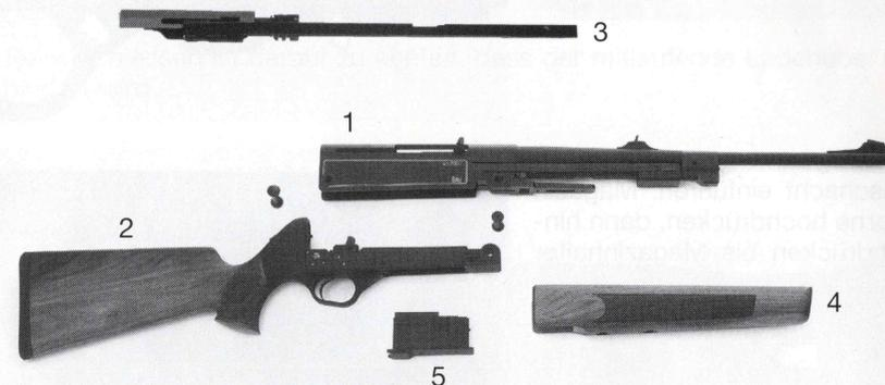
Wechselsystem: Zum Umbau auf ein anderes Kaliber wird immer die Hülse mit Rohr, vst., benötigt.
