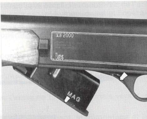
Basculer le chargeur garni vers le haut jusqu'à l'encliquetage de l'arretoir du chargeur.
