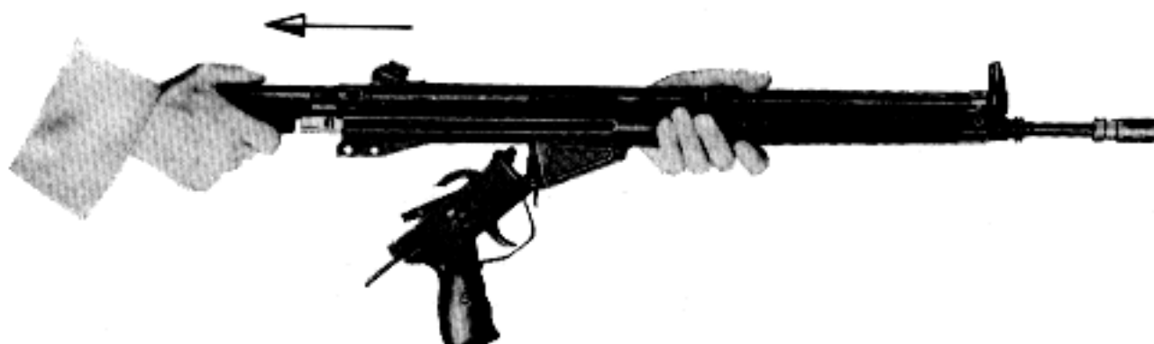
Fig. 64: Remove the bolt
