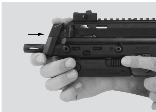
Fig. 37: Colocación de la tapa del cajón de mecanismos
