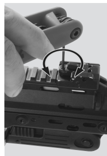
Fig. 39: Corrección en altura del punto de mira
