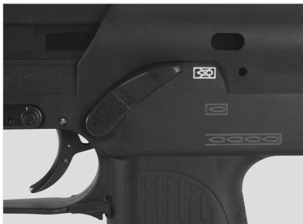
Fig. 11: Palanca del seguro en la posición de “Seguro”
