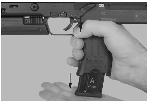
Fig. 14: Accionamiento del retén del cargador con el pulgar y el índice, extracción del cargador
