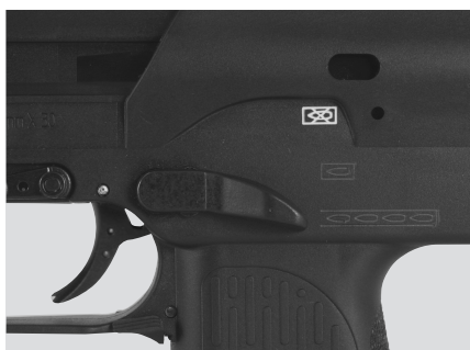
Fig. 13: Palanca del seguro en la posición de “Tiro continuo”
