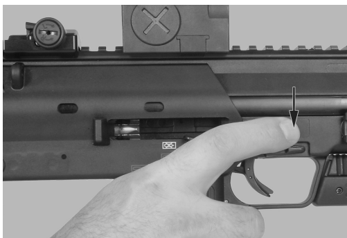
Fig. 17: Liberación del cierre accionando la palanca de retención del cierre
