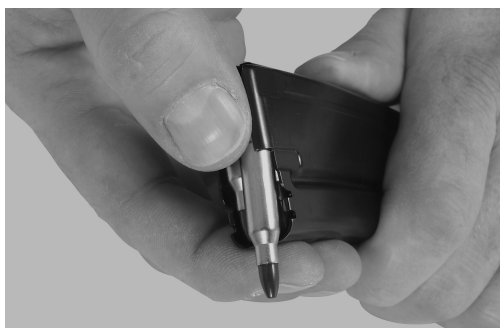
Fig. 20: Descarga del cargador
