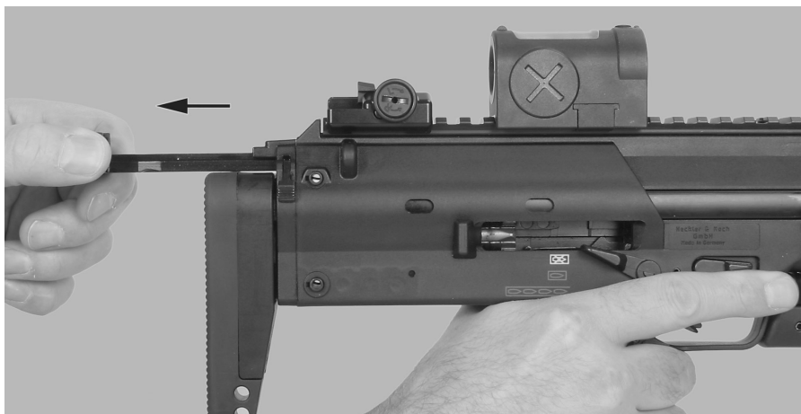
Fig. 16: Desplazamiento hacia atrás de la palanca de rearmado (carga total del arma)
