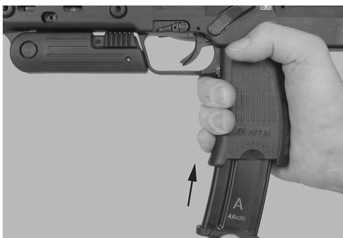
Fig. 15: Introducción del cargador
