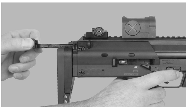
Fig. 18: Retención del cierre en posición abierta (sin cargador)
