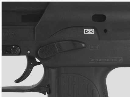
Fig. 12: Palanca del seguro en la posición de “Tiro a tiro”
