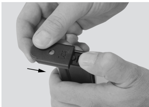
Fig. 38: Montaje del cargador
