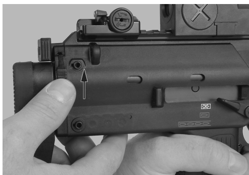
Fig. 7: Desenclavamiento del culatín retraído
