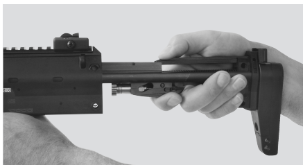
Fig. 36: Montaje del cajón de mecanismos y culatín con el cierre.
