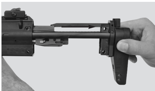
Fig. 31: Desmontaje del culatín, caja de fijación, palanca de rearmado, cierre y resorte recuperador
