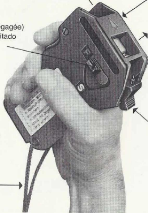
Fig. 3: Dispositivo lanzacartuchos de señales en posición de disparo
