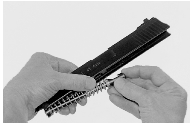
Pufferstange herausnehmen Remove the recoil/buffer spring guide rod
