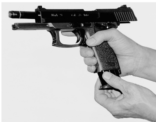
Magazinhalter betätigen mit dem Daumen der Schießhand
