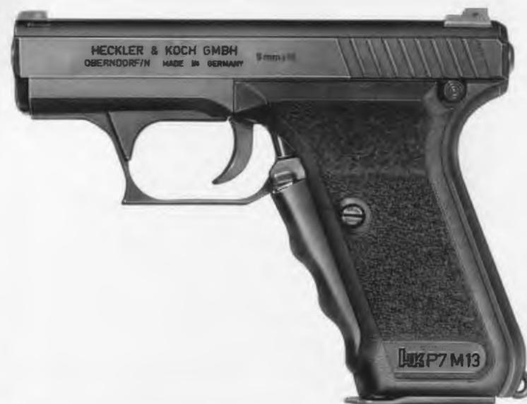
Hasta que no disminuye la presión de los gases, es decir, después del correspondiente retardamiento, no puede deslizarse hacia atrás el émbolo del cilindro y, con él, la corredera para realizar el movimiento de repetición. Esto permite otras ventajas, que son: El cañón fijo, dimensiones reducidas, piezas sencillas, supresión de un acerrojamiento mecánico.
