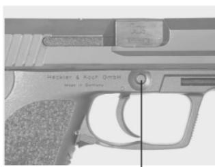
Posición del eje de la palanca de retención de la corredera
