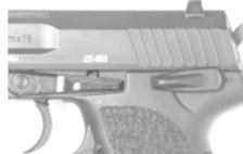
Entspannhebel, links; ohne manuelle Sicherung
