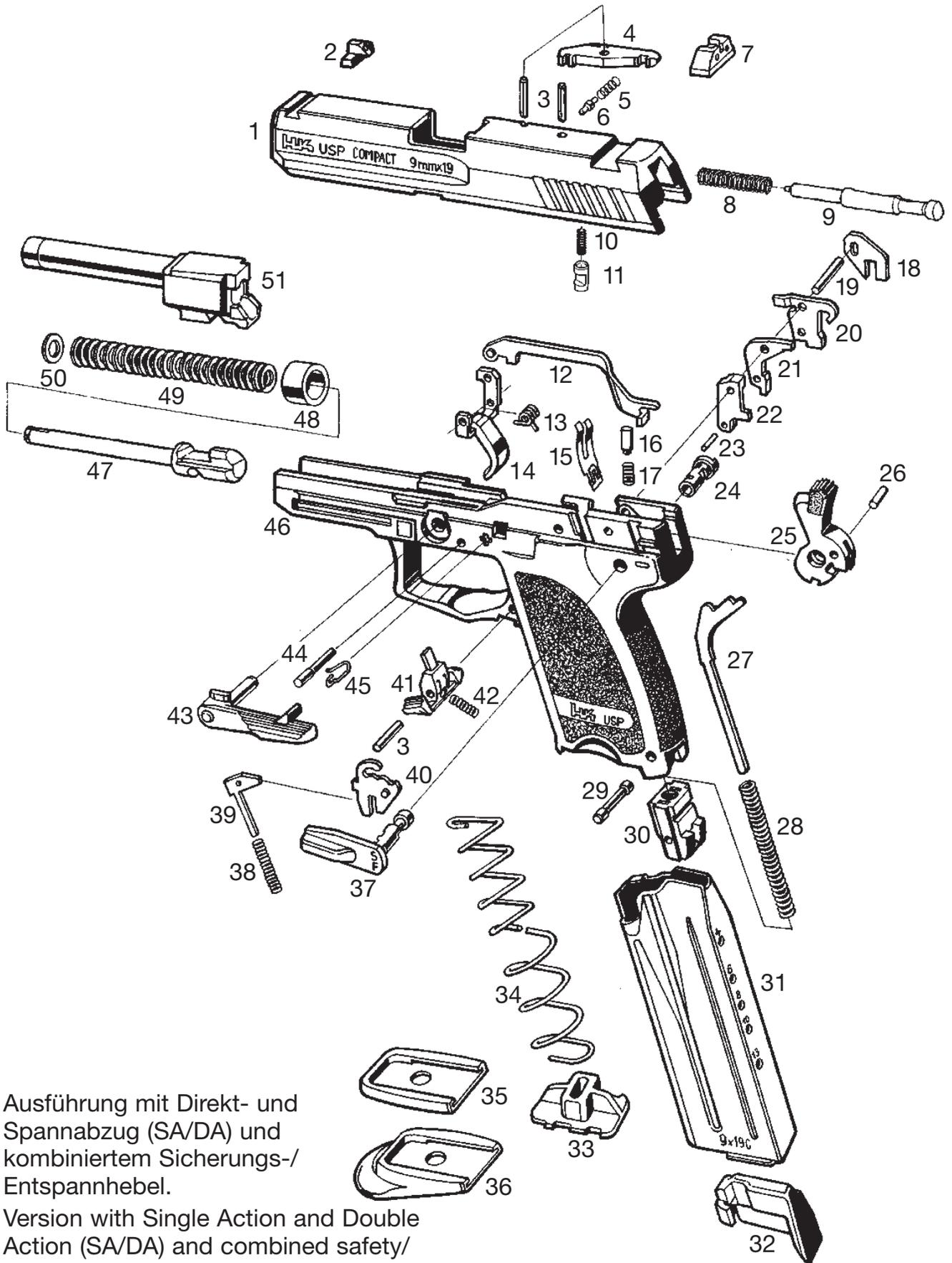
Ausführung mit Direkt- und Spannabzug (SA/DA) und kombiniertem Sicherungs-/Entspannhebel.
