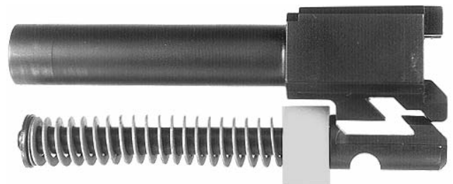
Lage Federführung - Rohr
