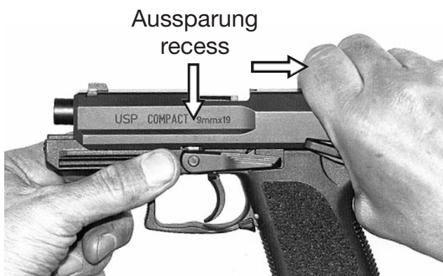
Lage Aussparung zu Verschlussfanghebel Position of the recess of the slide release
