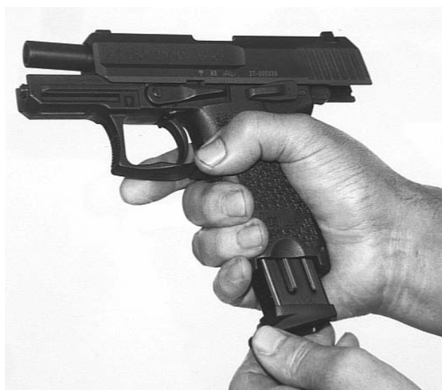
Magazinhalter betätigen mit dem Daumen der Schießhand
