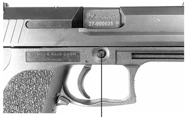
Achse Verschlussfanghebel Axle of the slide release
